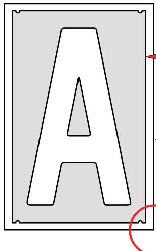
**1** Символьный трафарет буквы или цифры бортового регистрационного номера ГИМС состоит из бумажного основания (подложки), самоклеящейся пленки с контуром буквы или цифры, или вспомогательного элемента и верхнего слоя прозрачной монтажной пленки
